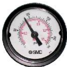
圖 1-3、液流系統車氣壓儀表，壓力測量大約為 88psi
